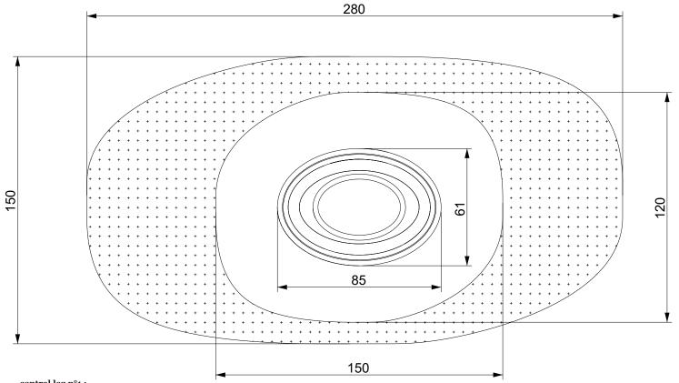
**central leg n°1 :** minimum length : 150 cm / maximum length : 280 cm minimum width : 120 cm / maximum width : 150 cm
